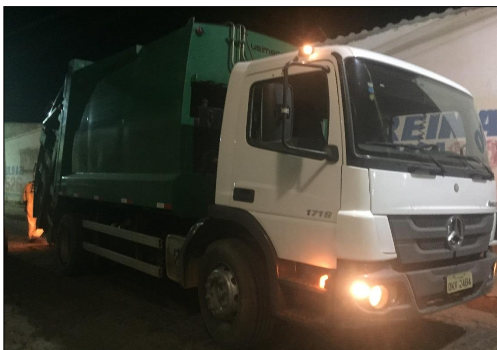
Figura 178 – Caminhão compactador utilizado para a coleta dos resíduos domiciliares.
