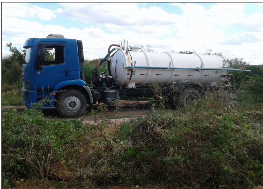
Figura 84 – Caminhão de limpeza e desobstrução da rede de esgoto. Fonte: DRZ – Geotecnologia e Consultoria, 2017.
