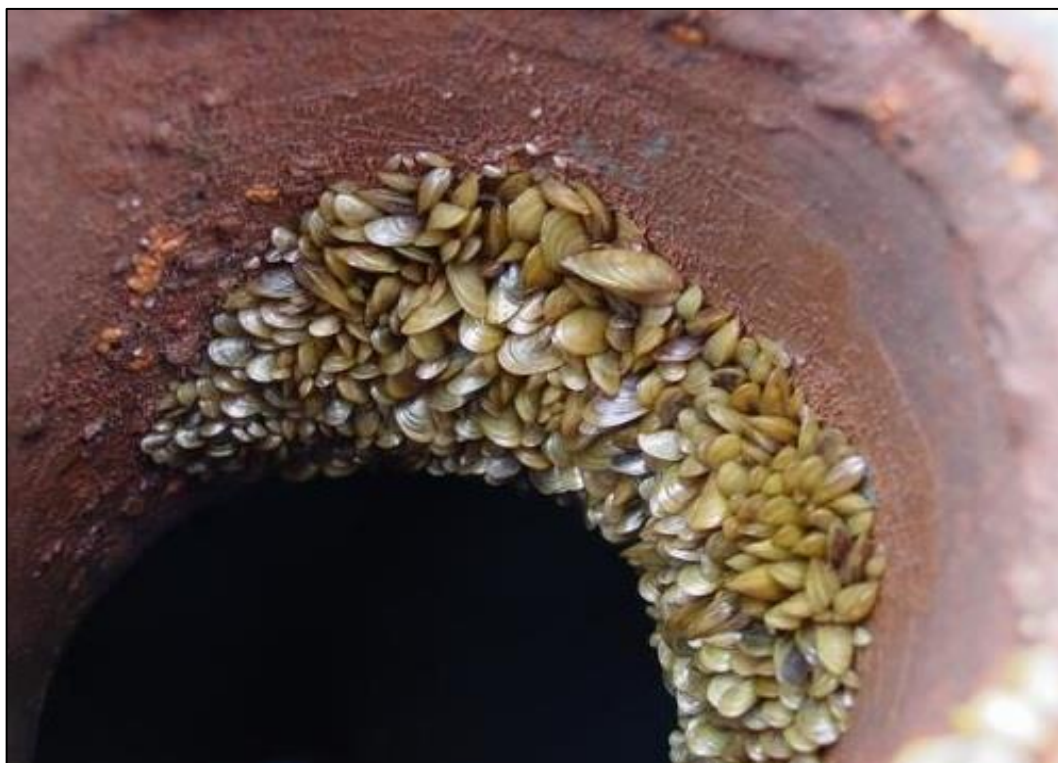
Figura 42 – Exemplo de mexilhões dourados presentes em tubulações. Fonte: http://www.ebanataw.com.br/mexilhaodourado/mexilhaodourado.php , 2006.
