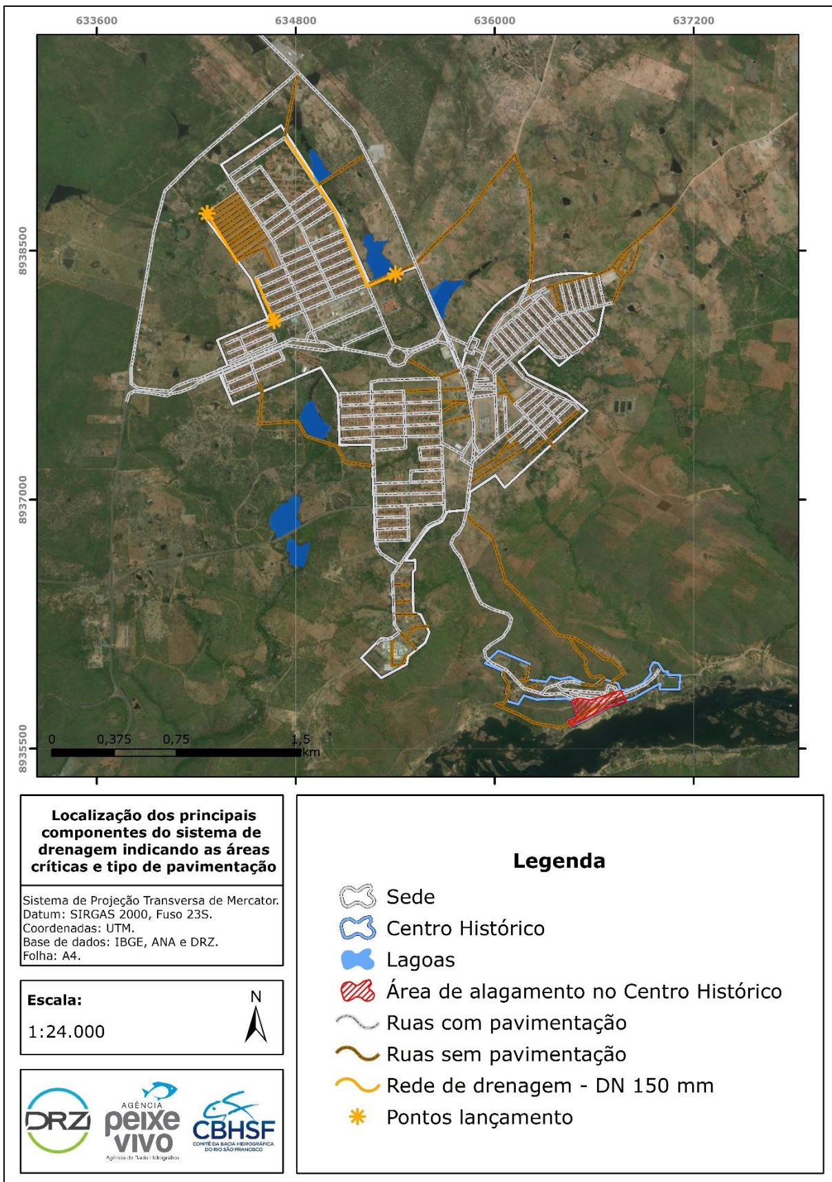
Figura 140 – Localização dos principais componentes do sistema de drenagem, indicando as áreas críticas e tipo de pavimentação. Fonte: DRZ – Geotecnologia e Consultoria, 2018.
