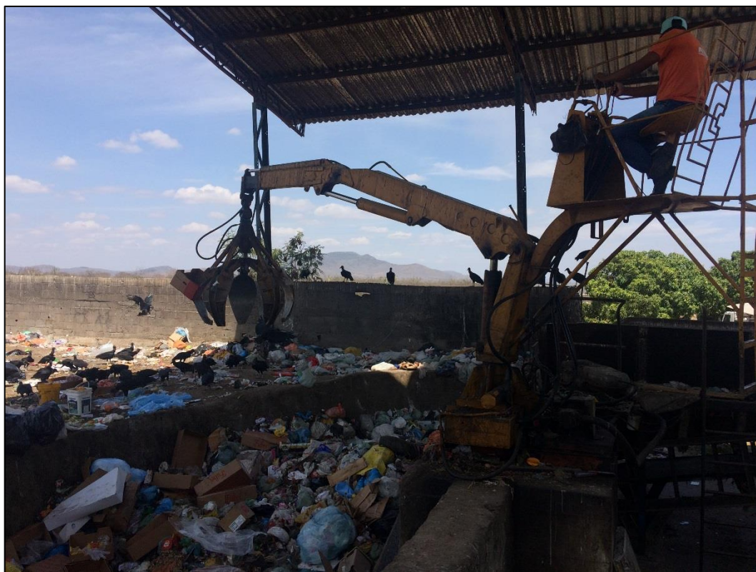
Figura 154 – Baía do galpão de triagem que recebe os resíduos da coleta domiciliar.
