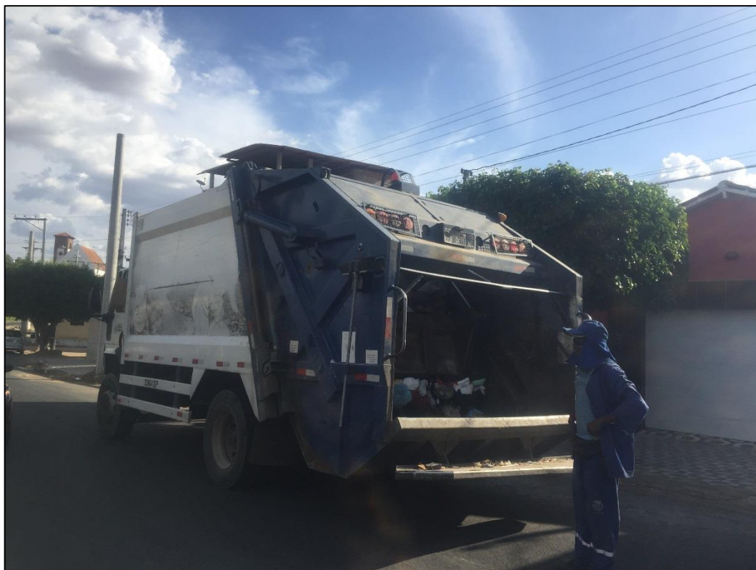
Figura 137 – Caminhão compactador utilizado na coleta domiciliar da área urbana.
