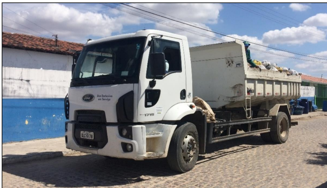
Figura 92 – Caminhão caçamba utilizado para a coleta dos resíduos domiciliares em São Cristóvão.
