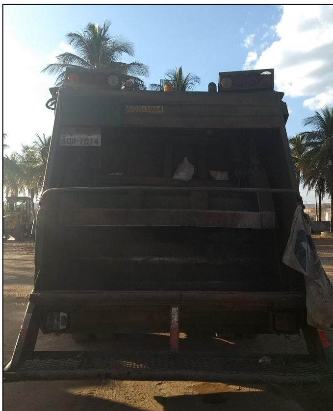
Figura 168 – Vista traseira do caminhão compactador. Fonte: DRZ – Geotecnologia e Consultoria, 2017.
