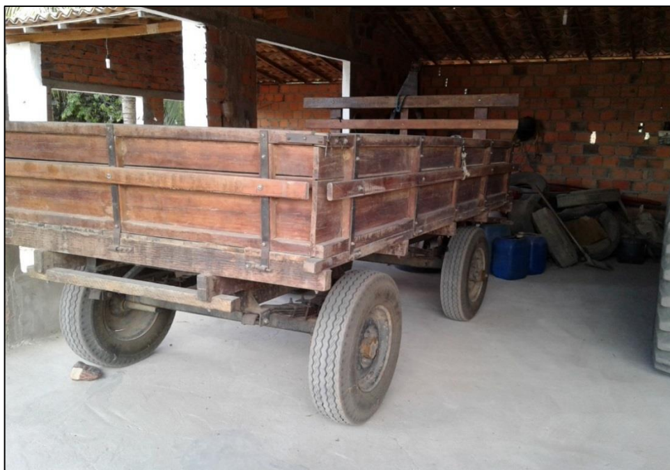
Figura 202 – Carroceria que é acoplada ao trator utilizado para a coleta de resíduos na comunidade Brancos.
