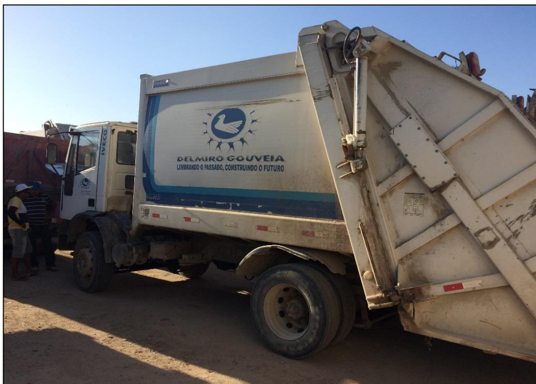
Figura 143 – Caminhão compactador utilizado para a coleta dos resíduos domiciliares.
