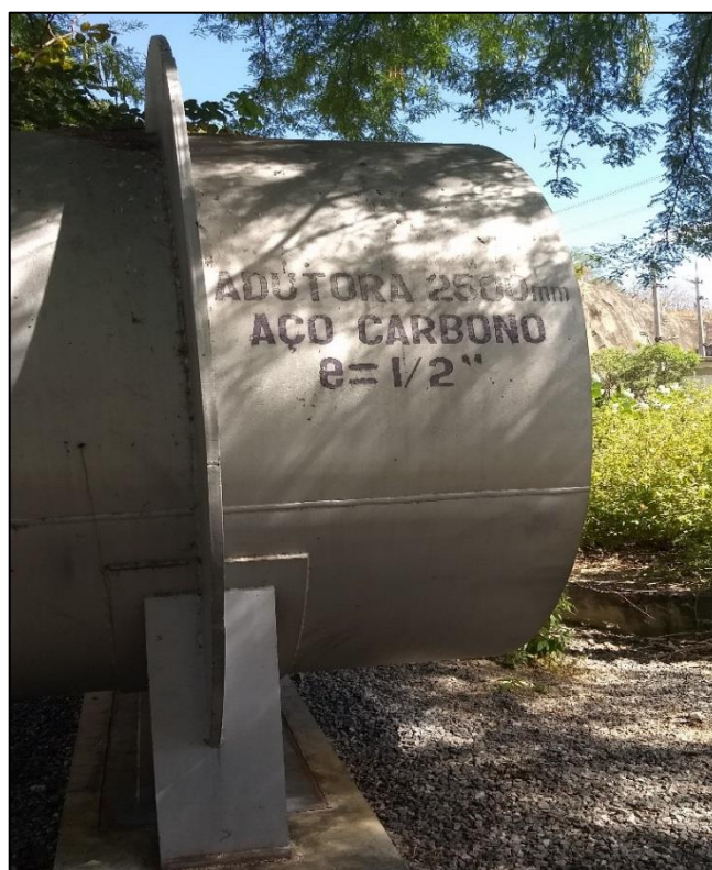
Figura 39 – Características da Adutora de Água Bruta (AAB) do Projeto Jacaré Curitiba.
