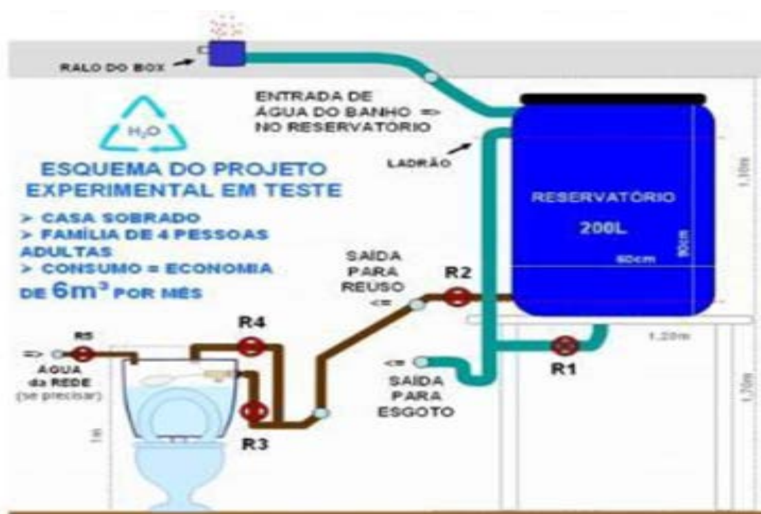
Figura 25 – Esquema Simplificado de Reuso de Efluente Fonte: SOCIEDADE DO SOL, 2013
