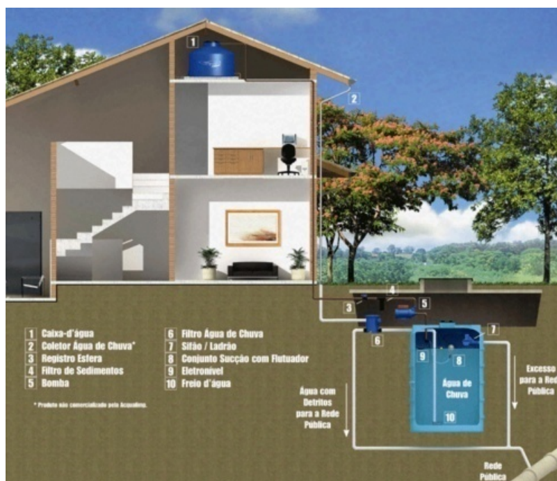
Figura 21 – Esquema de Captação de Água de Chuva
