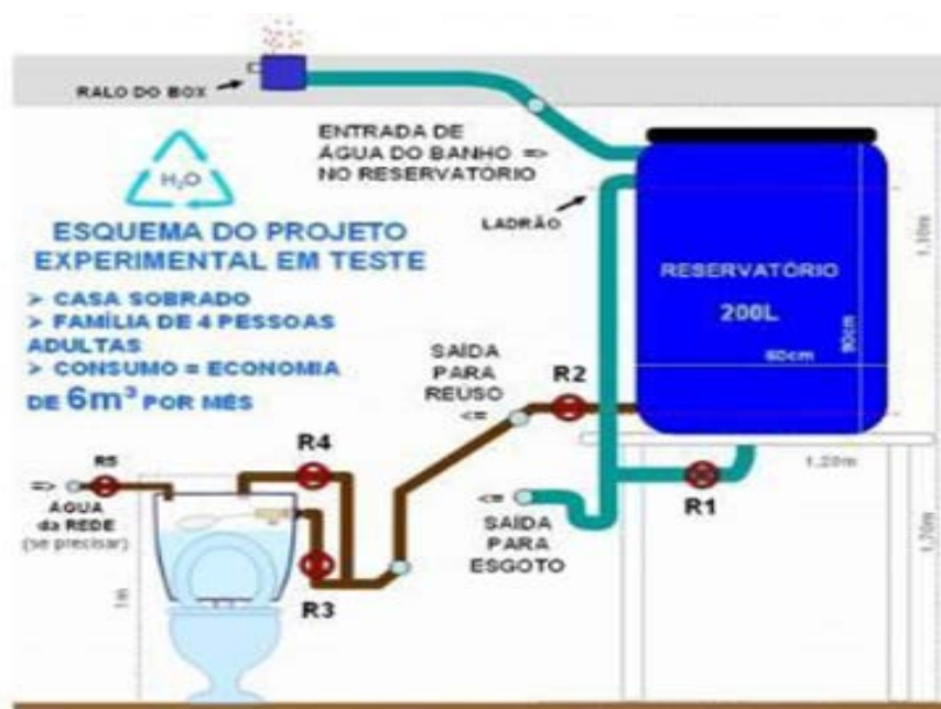
Figura 30 – Esquema Simplificado de Reuso de Efluente Fonte: SOCIEDADE DO SOL, 2013
