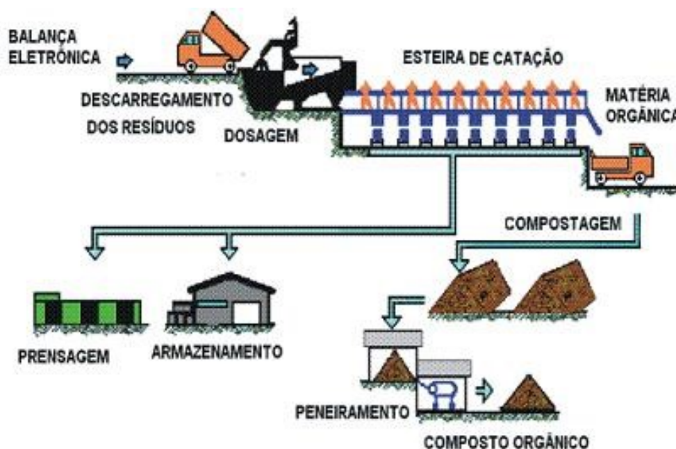
Figura 54 – Fluxograma Operacional da Unidade de Triagem e Compostagem (UTC)
