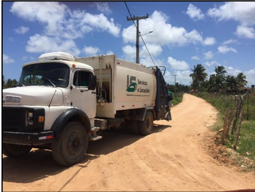
Figura 66 – Caminhão compactador utilizado na coleta (vista lateral) Fonte: Premier Engenharia, 2018.
