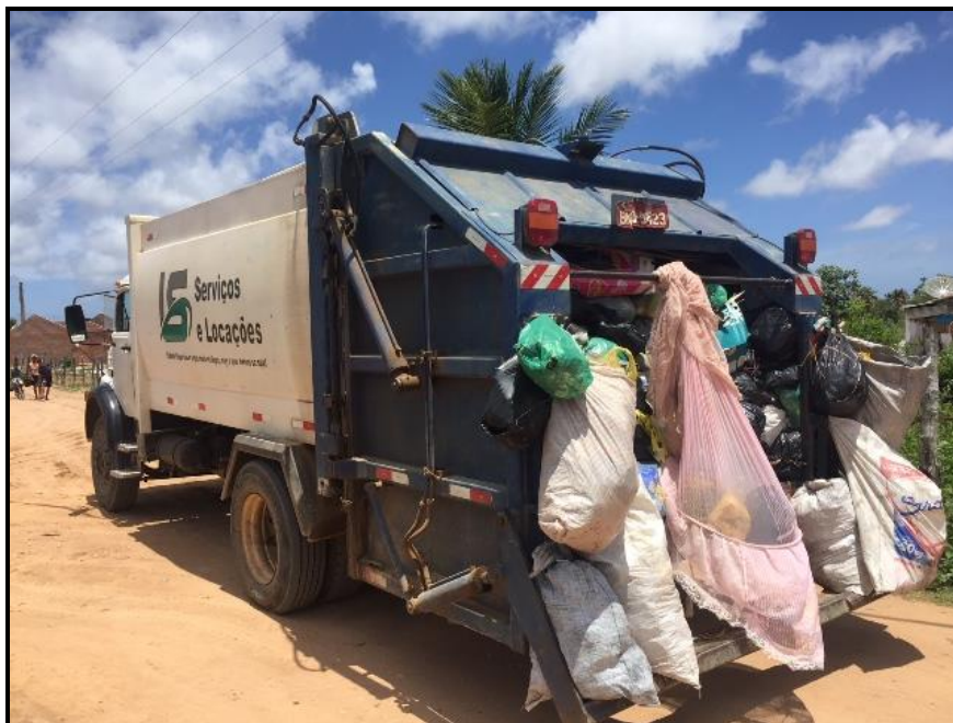
Figura 67 – Caminhão compactador utilizado na coleta (vista da traseira) Fonte: Premier Engenharia, 2018.
