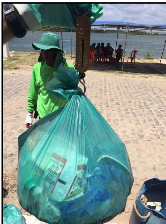
Figura 58 – Pesagem dos componentes da amostra Fonte: Premier Engenharia, 2018.
