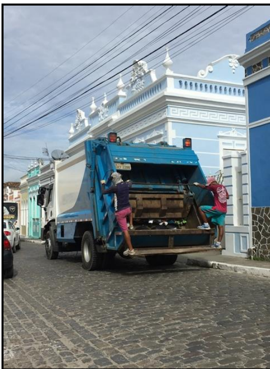
Figura 177 – Caminhão compactador utilizado na coleta convencional Fonte: Premier Engenharia, 2018.
