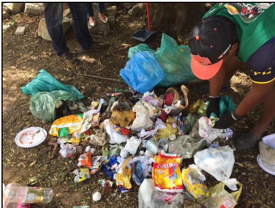
Figura 77 – Triagem da amostra do material coletado Fonte: Premier Engenharia, 2018.
