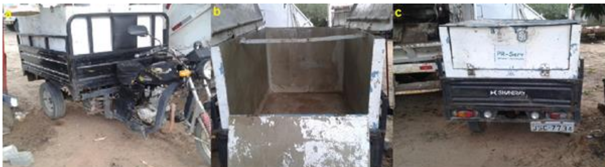
Figura 10.26 – Veículo tipo triciclo utilizado para coleta de resíduos de serviço de saúde (a); vista interior do veículo (b) e vista da programação visual do veículo.
